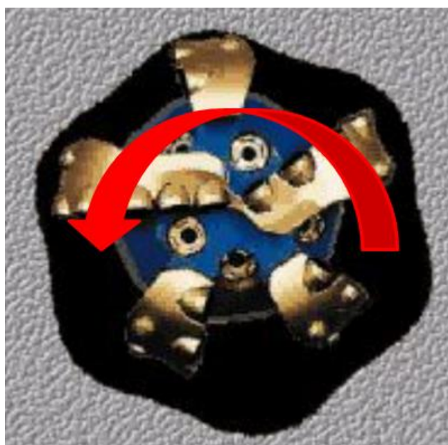
Рисунок 2. Многоугольное сечение скважины, образованное завихрением долота
