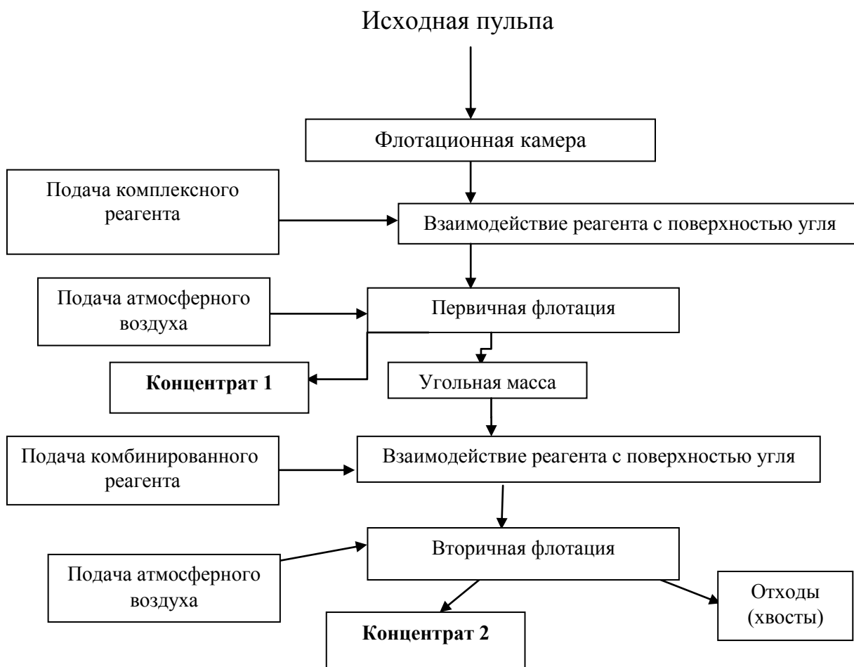
Рисунок 2. Принципиальная схема флотации угля с применением комплексного реагента
