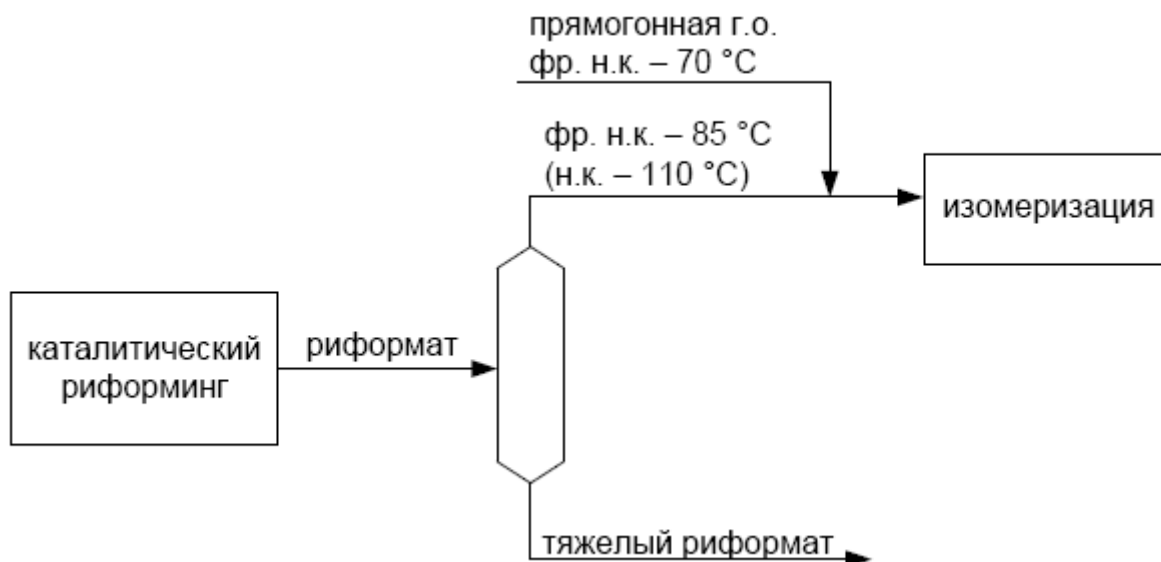
Рисунок 2 – Комбинирование процессов каталитического риформинга и изомеризации выделением фракции н.к.-85 °С (110 °С) из риформата
