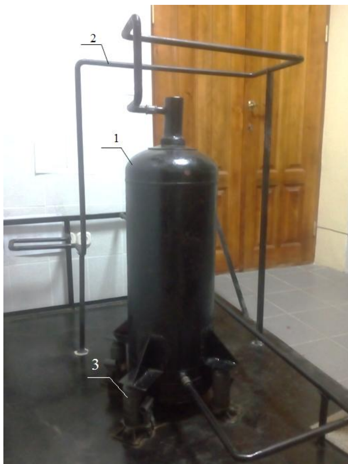
Рисунок 1. Макет реактора с трубопроводной обвязкой: 1 – реактор, 2 – трубопроводная обвязка, 3 – кронштейны
