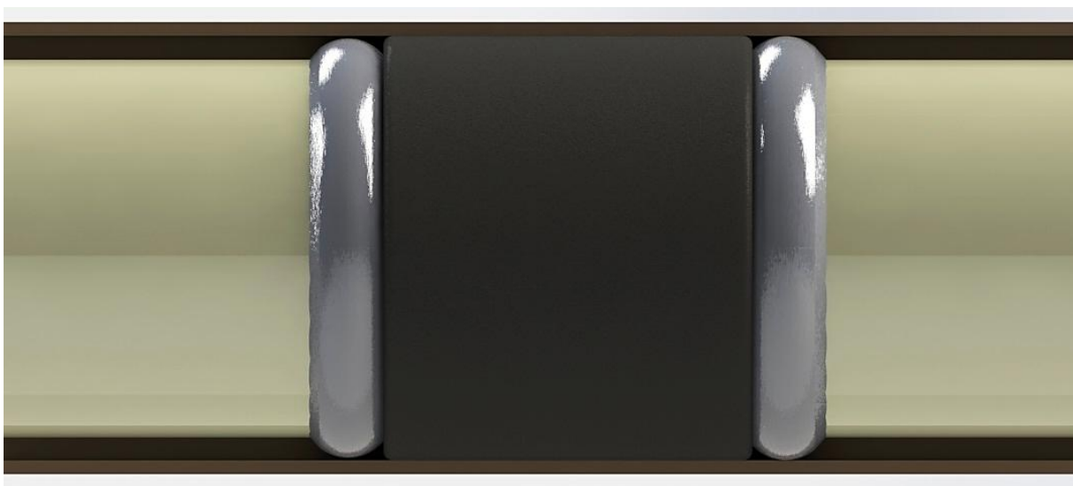
Рисунок 4. Резина пакера в сжатом состоянии
