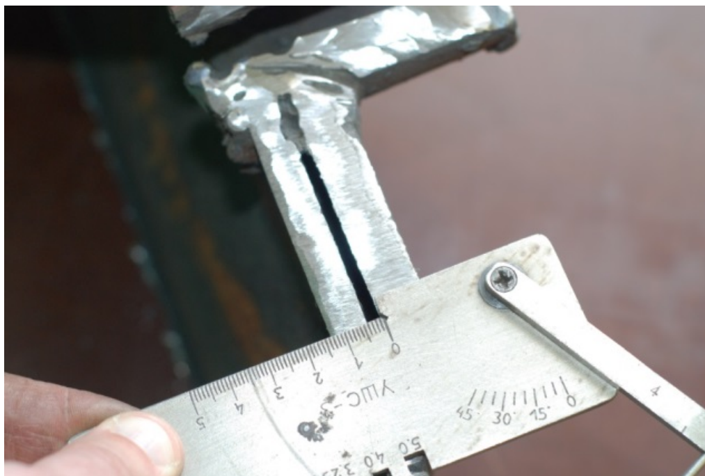
Рисунок 1. Зазор в штуцерном узле, укрепленном накладным кольцом
