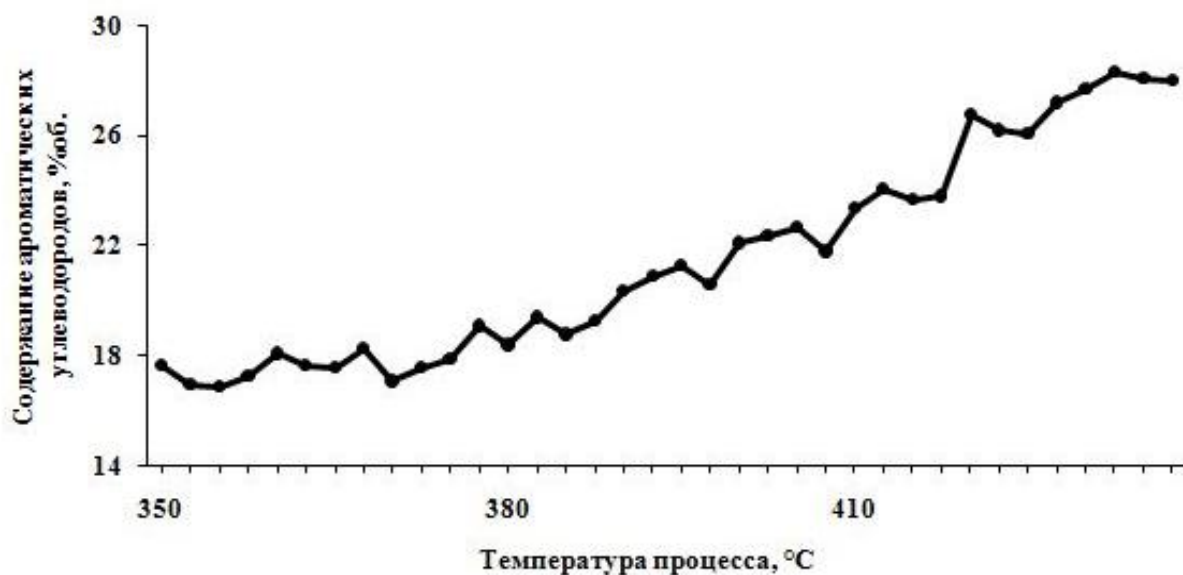
Рисунок 3. Изменение содержания ароматических углеводородов в продуктах ароматизации бензина от температуры (до регенерации), % об.
