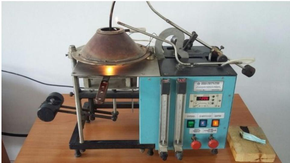
Рисунок 4. Испытательная установка для определения воспламеняемости строительных материалов
