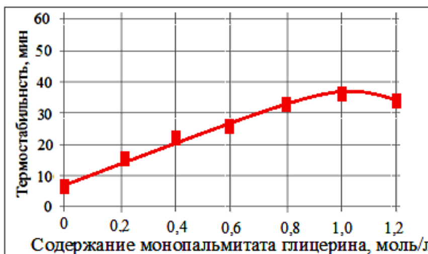
Рисунок 3. Зависимость термостабильности ( T = 190\text{ }^{\circ}\text{C} ) ПВХ-композиции от содержания в многофункциональном стабилизаторе монопальмитата глицерина
