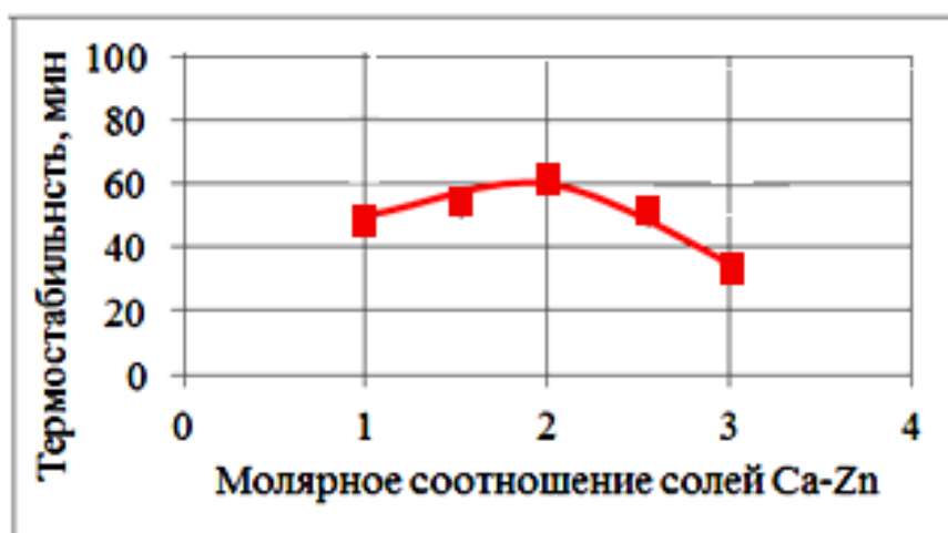
Рисунок 1. Влияние молярного соотношения пальмитатов кальций-цинка на термостабильность ПВХ при 160 °С: 1 – соли Ca : соли Zn = 1,25:0,75; 2 – соли Ca : соли Zn = 1,5:0,5; 3 – соли Ca : соли Zn = 1:1
