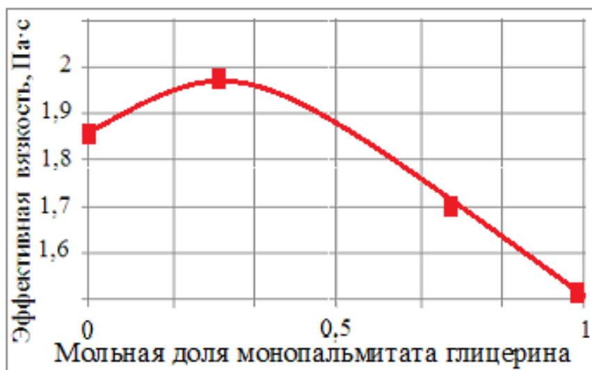
Рисунок 2. Зависимость эффективной вязкости ( T = 180\text{ }^{\circ}\text{C} ) ПВХ–композиции от содержания в многофункциональном стабилизаторе монопальмитата глицерина
