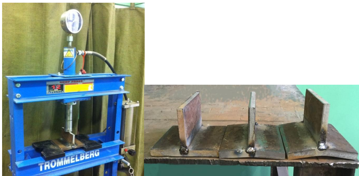
Рисунок 6. Сварка образцов с выгибом
