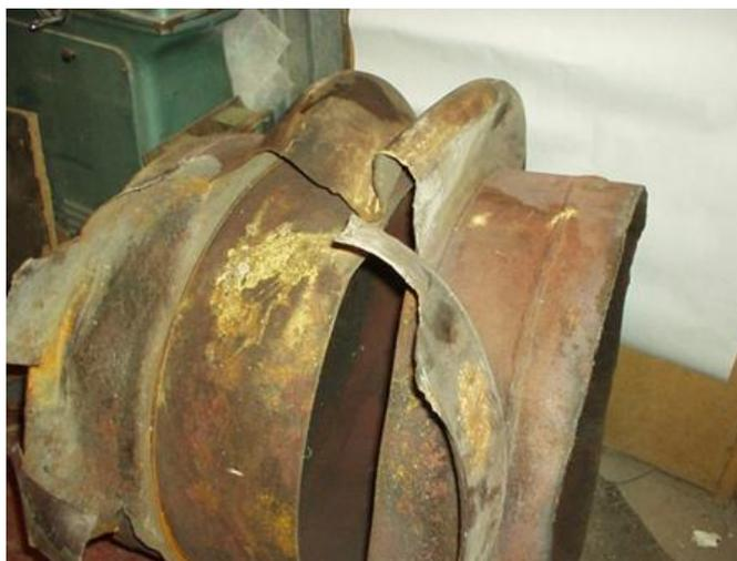
**Рисунок 1.** Разрушенный компенсатор
