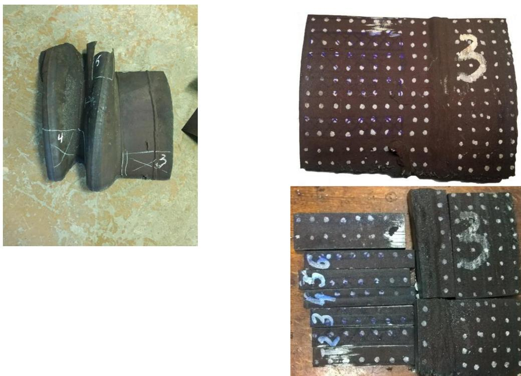
**Рисунок 2.** Разметка и разделка фрагментов на образцы для проведения испытания
