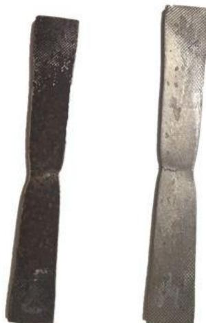
**Рисунок 4.** Компактные образца после испытания на растяжение
