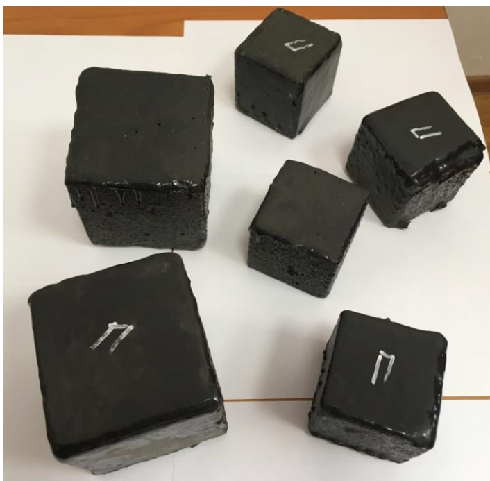
Рисунок 3. Бетонные образцы, покрытые полимочевиной
