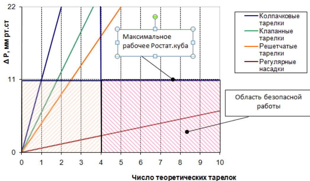
Рисунок 5. Рабочая область получения ГП ИПБ в одну стадию (при P_{\text{остат.верха}} = 3 мм рт. ст.)
