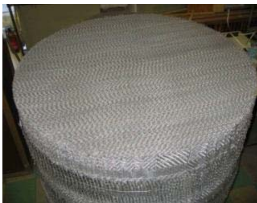
Рисунок 6. Конструкция регулярной насадки «ГИПХ»
