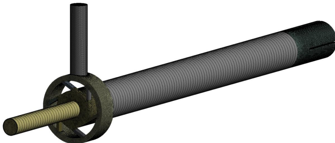
Рисунок 5. Сетка конечных элементов
