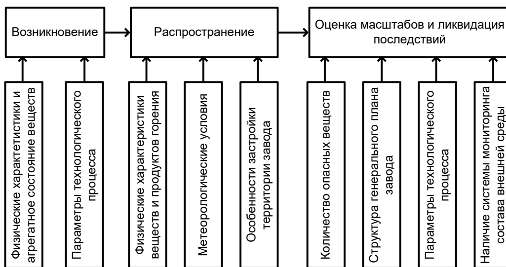
Рисунок 1. Основные параметры, определяющие опасность пожара или взрыва на всех этапах развития инцидента
