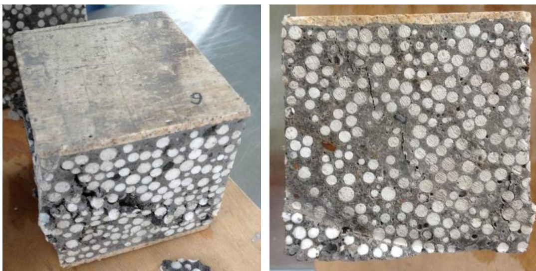
Рисунок 2. Образцы панелей после испытания на сжатие
