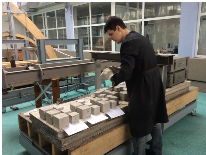
Рисунок 1. Подготовка образцов для физико-механических испытаний трехслойных полистиролбетонных панелей
