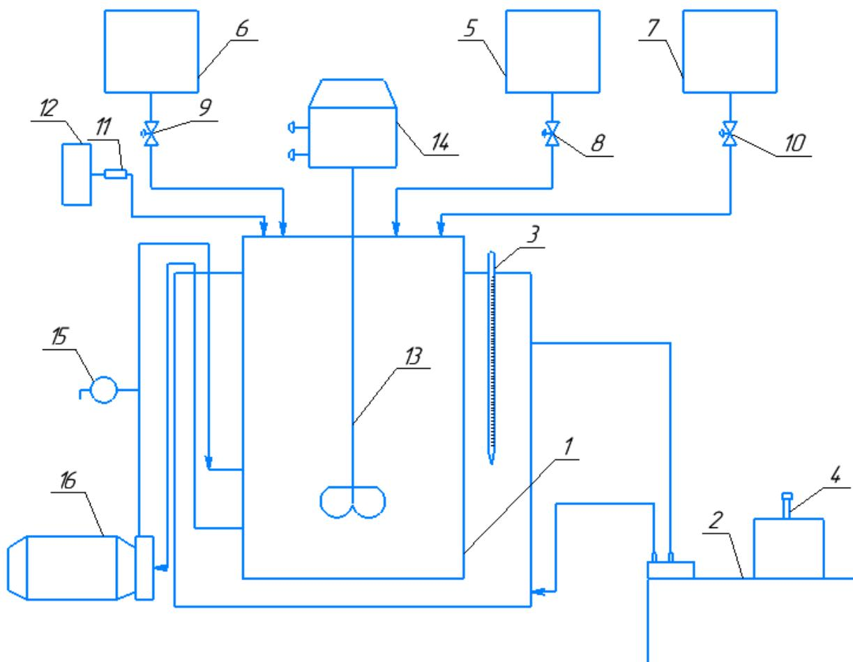
1 – емкость для эмульгирования; 2 – термостат; 3, 4 – термометры,
