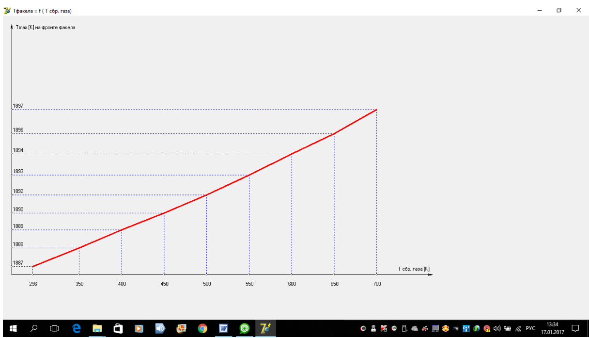
Рисунок 3. Изменение температуры пламени от температуры сбрасываемого газа
