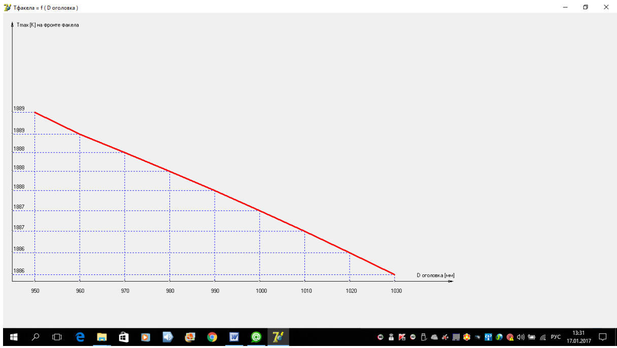
Рисунок 2. Изменение температуры пламени от диаметра оголовка трубы
