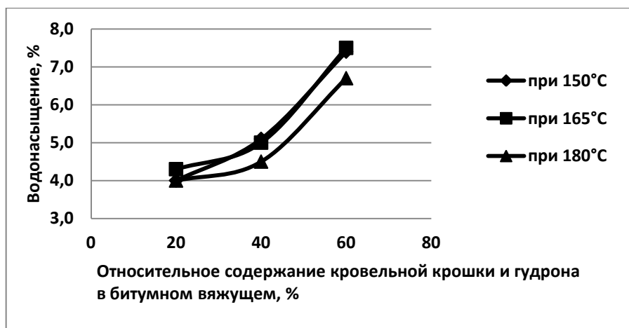
Рисунок 3. Изменение водонасыщения в зависимости от содержания кровельной крошки и гудрона в битумном вяжущем (%) и различной температуре перемешивания
