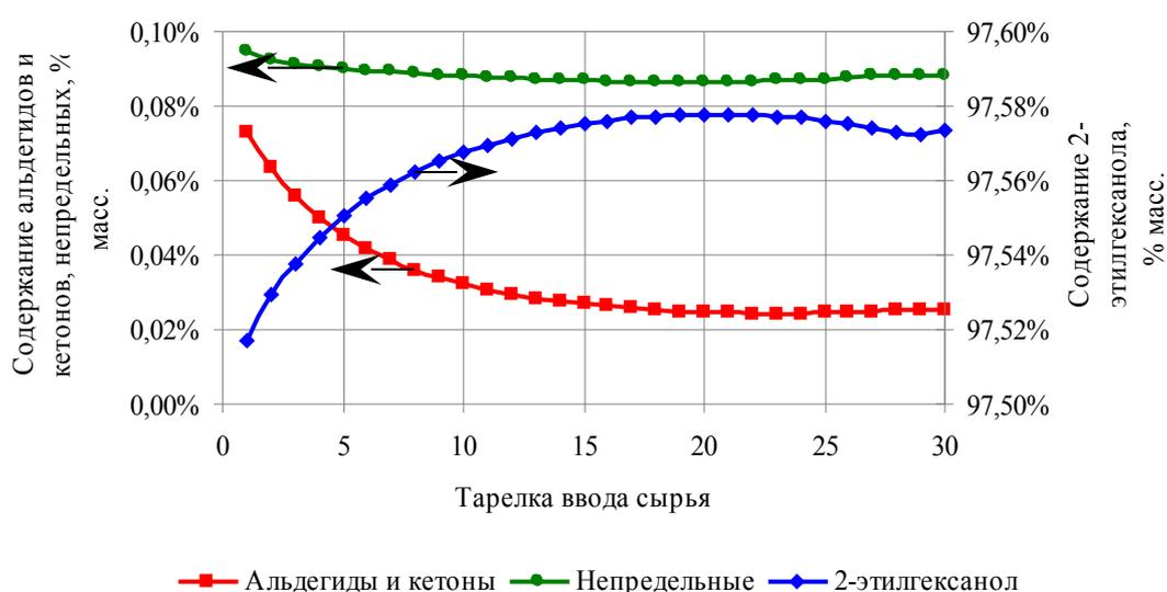
Рисунок 2. Графики зависимости содержания альдегидов и кетонов, непредельных соединений и 2-ЭГ в кубовом продукте от тарелки ввода
