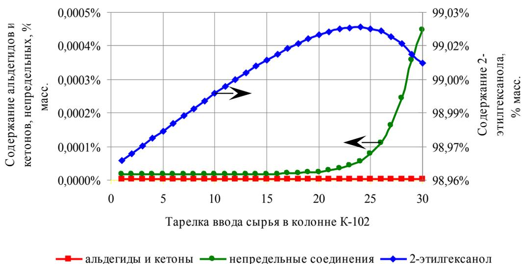
Рисунок 5. Графики зависимости содержания альдегидов и кетонов, непредельных соединений и 2-ЭГ в целевом продукте от тарелки питания колонны 6
