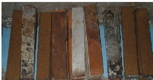
Рис. 2. Заготовки образцов, вырезанных из темплетов
