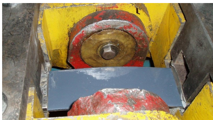
Рис. 7. Образец в захватах лабораторной установки
