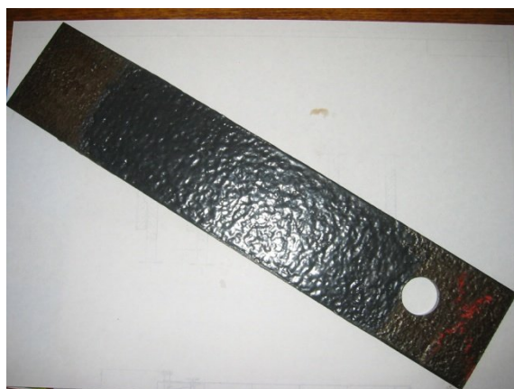
Рис. 3. Образец из темплета с нанесенным покрытием
