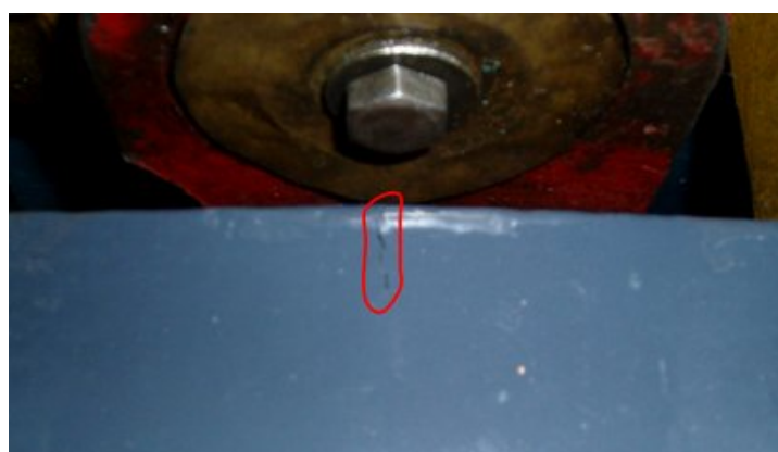
Рис. 8. Раскрытие трещины во время испытания
