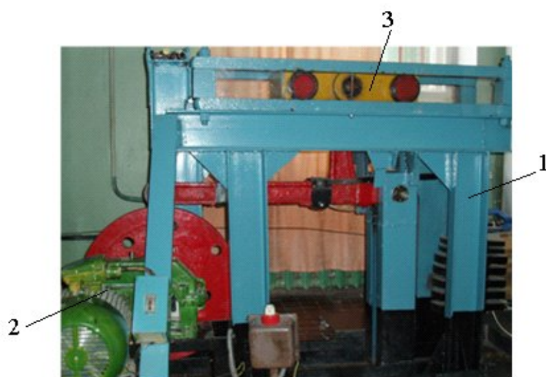
Рис. 6. Внешний вид установки 1 – каркас; 2 – привод; 3 - захваты
