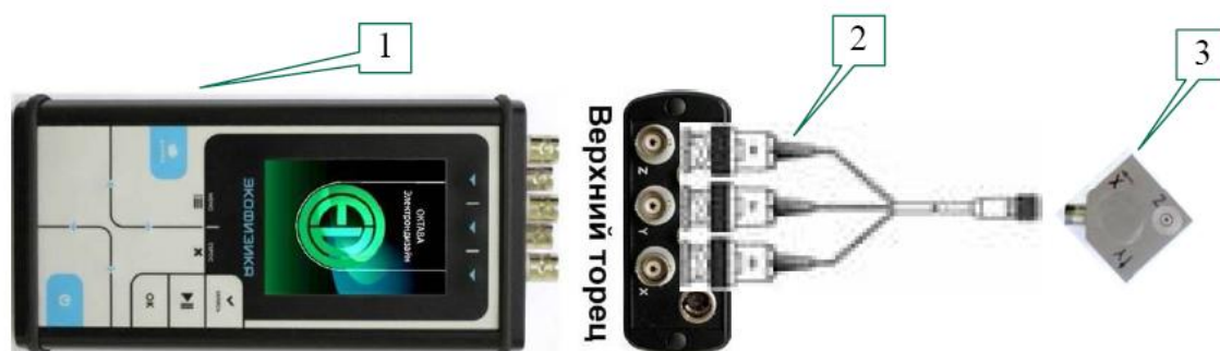
Рисунок 2. Общий вид прибора «ЭКОФИЗИКА-110А»: 1 – ИБ ЭКОФИЗИКА-D с ИМ НФ; 2 – кабель Микроdot-3xBNC; 3 – трехкомпонентный IERE-датчик
