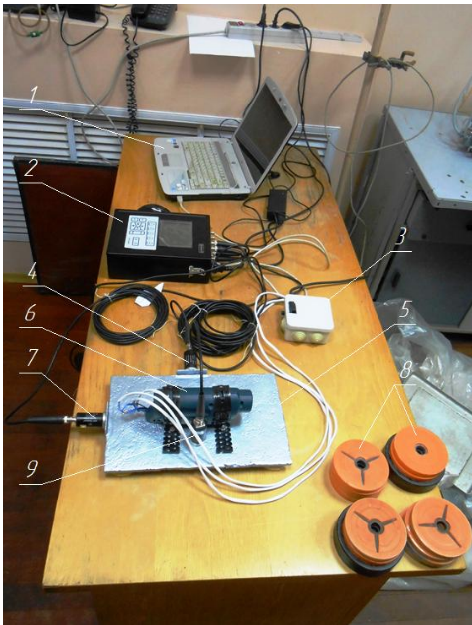
Рисунок 5. Экспериментальная установка для исследования прототипа виброизолятора с квазинулевой жесткостью тарельчатой формы 1 – компьютер; 2 – регистратор-анализатор вибросигналов «Диана-8»; 3 – блок управления; 4 – датчик №1; 5 – опытная установка; 6 – электродвигатель; 7 – датчик №3; 8 – пригрузки; 9 – датчик №2
