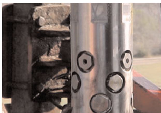
Рисунок 2а. Hydra-Jet™ – специальная гидромониторная насадка для проведения операции SurgiFrac [5]
