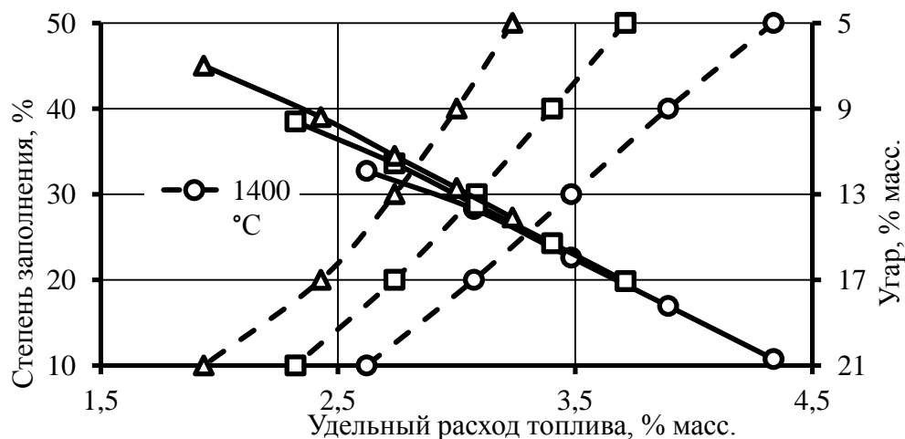
Рисунок 4. Зависимость влияния угара (сплошные линии) и степени заполнения печи (пунктирные линии) на удельный расход топлива при различных конечных температурах активации углеродного материала (цифры на линиях, конечная температура активации углеродного материала)
