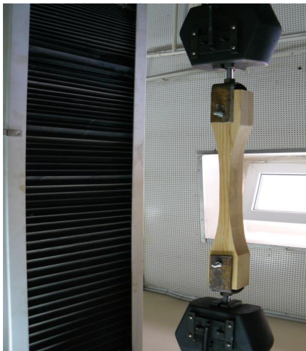
Рисунок 2. Деревянный образец, установленный в захват разрывной машины для определения предела прочности
