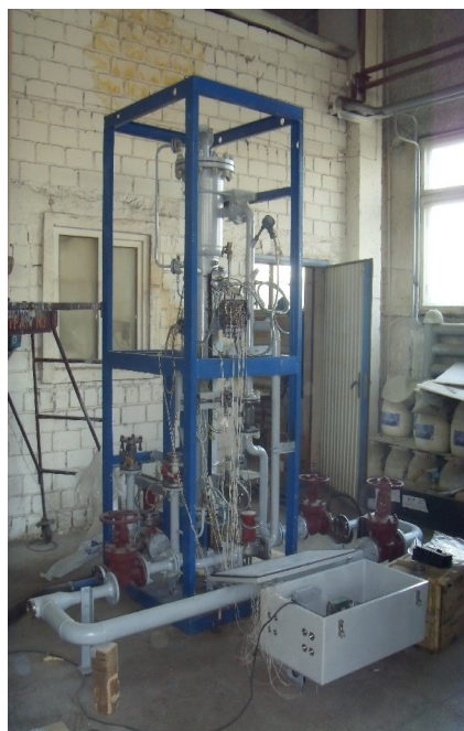
Рис. 2. ТРИУ в процессе заводских стендовых испытаний
