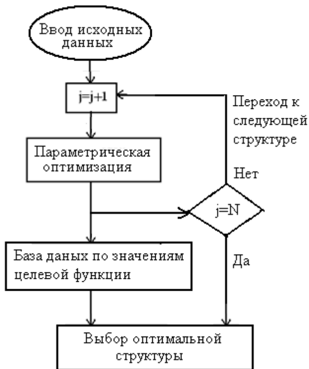
Рисунок 2. Однокритериальная структурно-параметрическая оптимизация с последовательным перебором всех возможных структур
