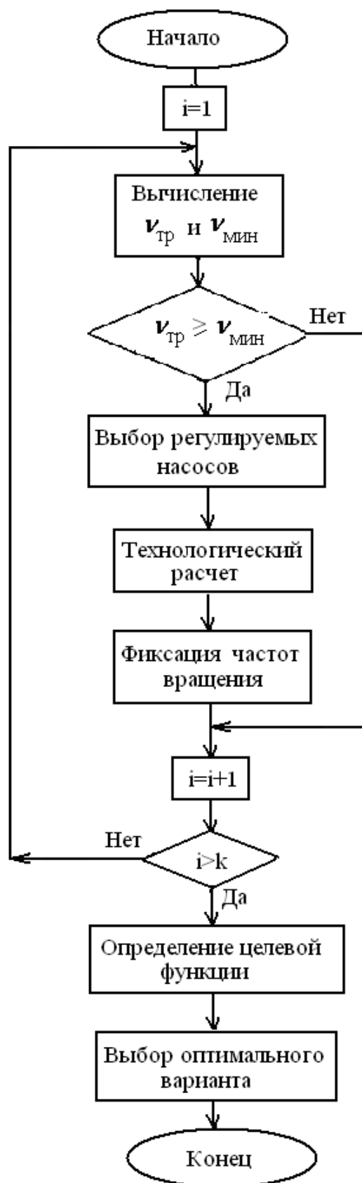
Рисунок 1. Структурная схема алгоритма управления ЦРЭП
