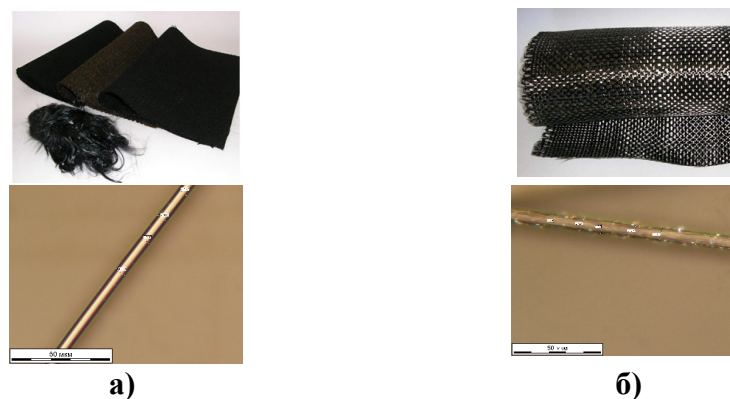
Рисунок 1. Углеродные волокна (x50): а) УВИС АК-П; б) УКН-М
