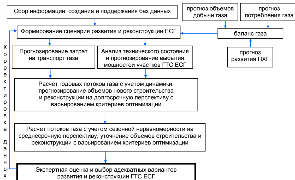
Рисунок 1. Формирование схемы развития и реконструкции ГТС ЕСГ Системный подход к разработке схемы развития и реконструкции ГТС ЕСГ
