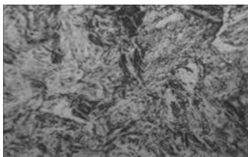
Сварка с предварительным подогревом при температуре 300-350°C с послесварочной термообработкой
