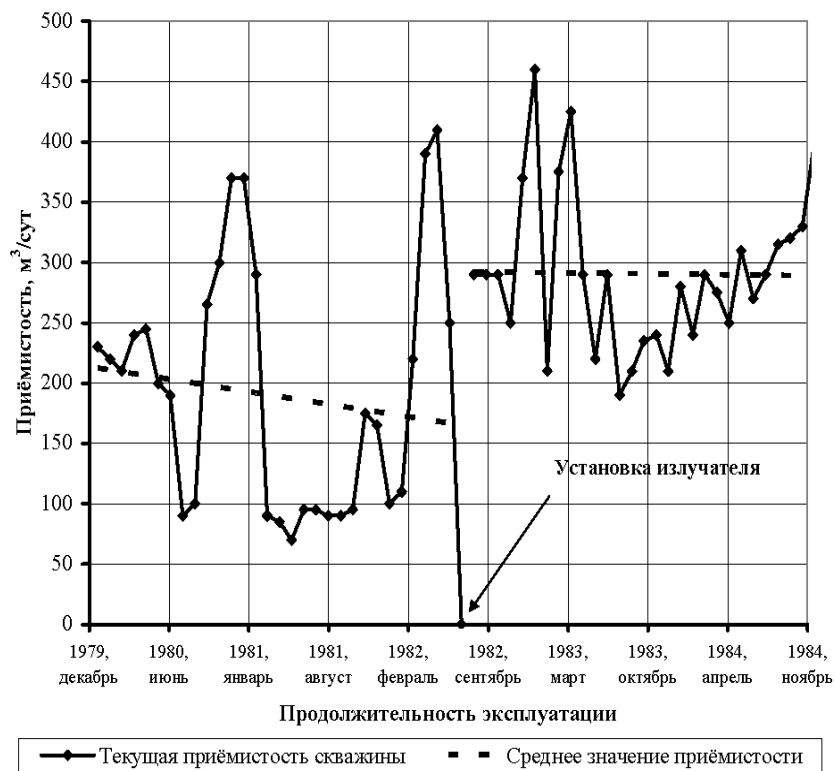
Рис. 2.1. Изменение приёмистости нагнетательной скв. №203
