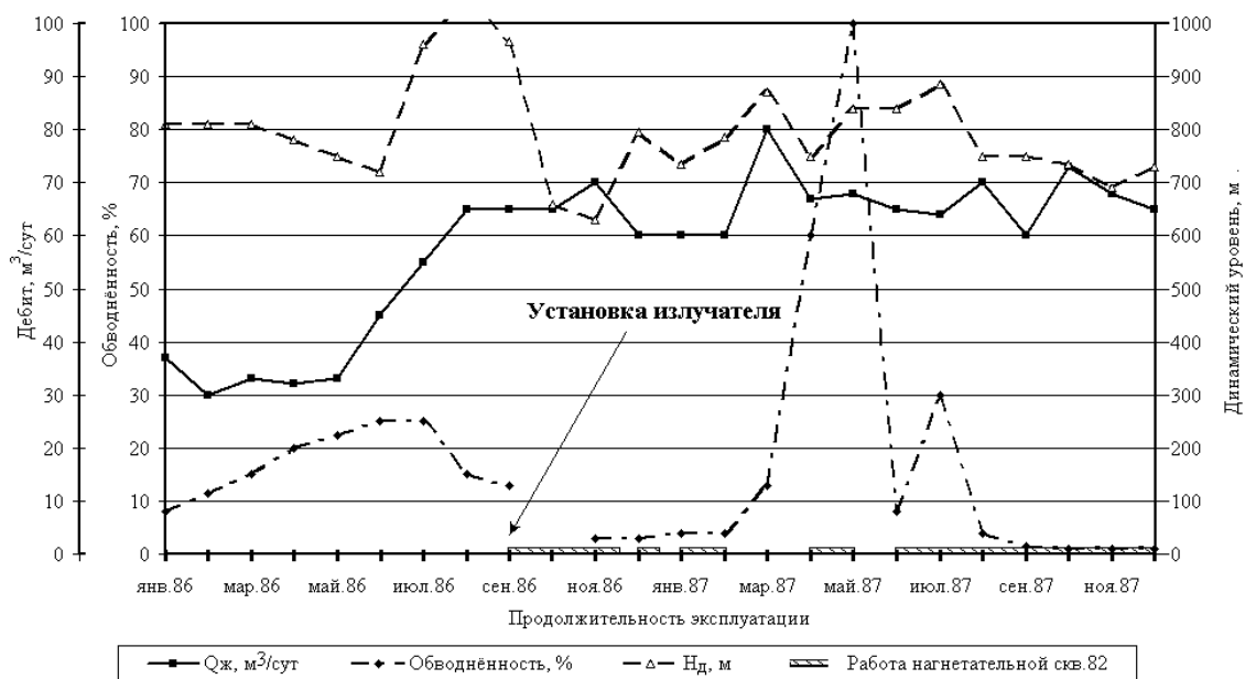
Рис. 2.5. График эксплуатации добывающей скважины №543
