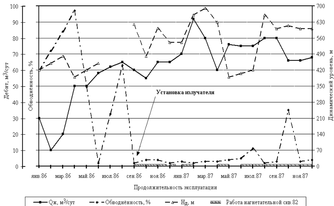
Рис. 2.6. График эксплуатации добывающей скважины №534
