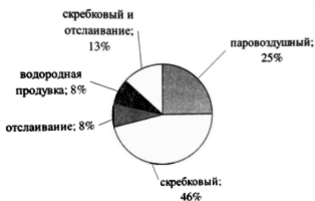
Рисунок 1. Способы раскоксовывания печных змеевиков
