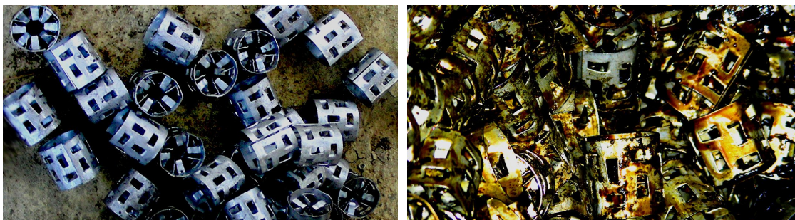
Рис. 2. Кольца Палля до загрузки и после извлечения.
