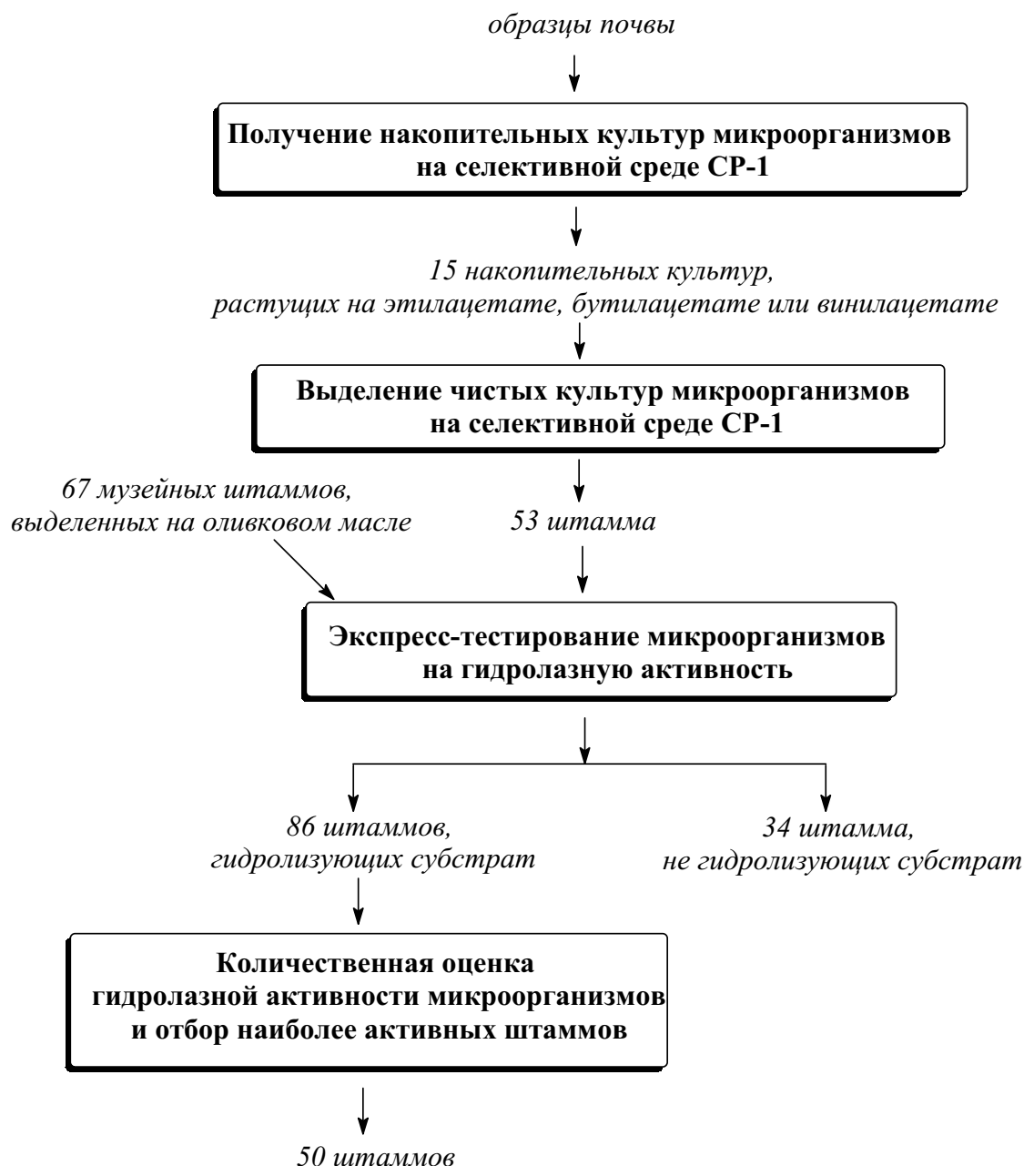
Рис. 1. Схема скрининга микроорганизмов с эстеразной активностью: СР1 – минеральная среда, содержащая этилацетат, винилацетат и бутилацетат, температура 30 °С, концентрация субстрата 5 г/л, время реакции 5 ч.
