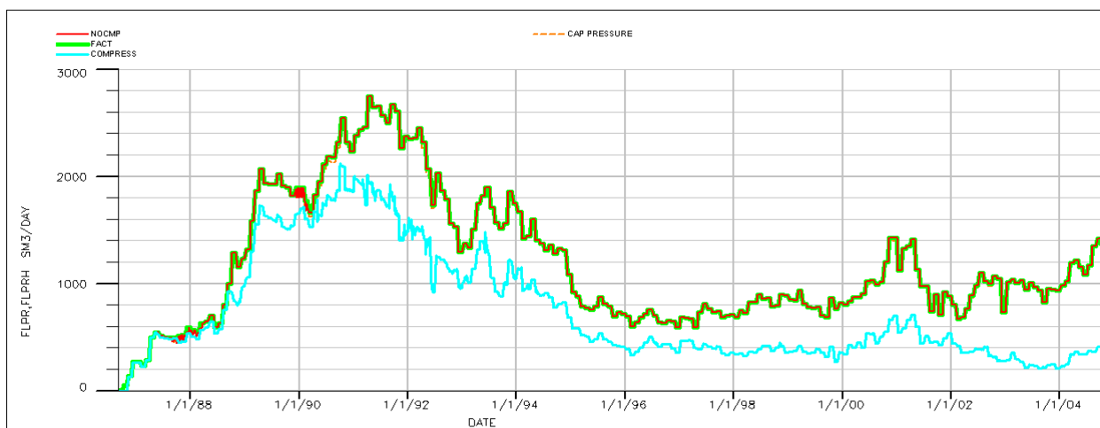
Рисунок 5. Добыча жидкости (3 залежь, пласт БС10 тсп , Мамонтовского месторождения): красная линия – модель вертикального равновесия, зеленая – фактическая кривая, голубая – модель вертикального равновесия со сжатием, пунктирная – использование истинных кривых капиллярного давления.
