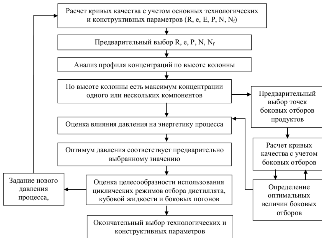
Рис. 3. Алгоритм оптимизации одноколонных аппаратов непрерывного действия
