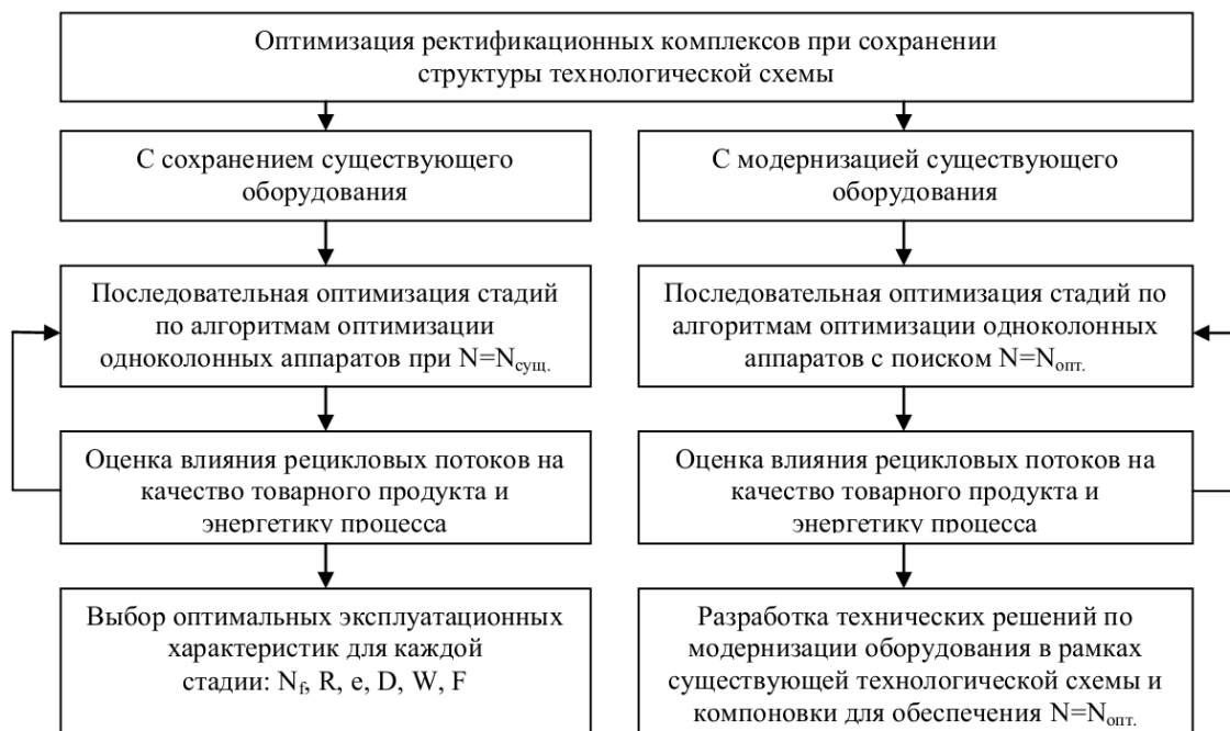
Рис. 1. Алгоритм оптимизации многоколонных ректификационных комплексов без изменения технологической схемы процесса
