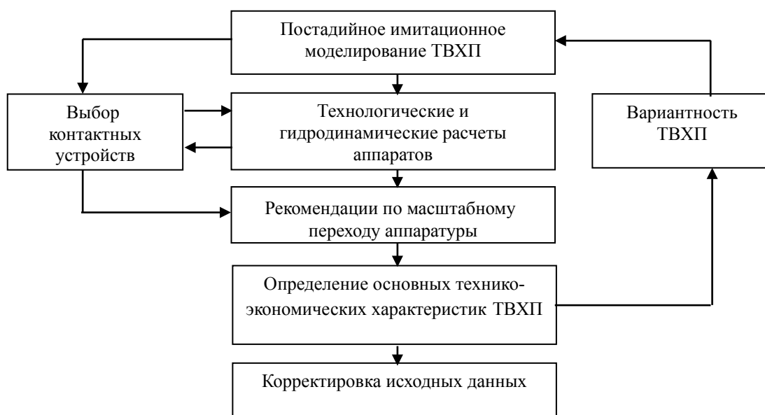
Рис. 4. Последовательность аппаратно-технологической оптимизации при стационарных условиях работы
