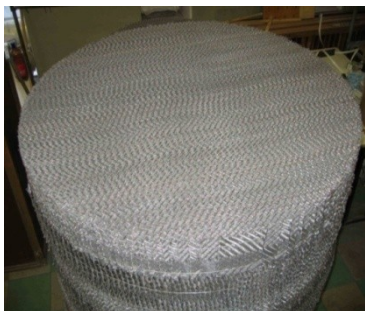
Рис. 2. Пакеты упругой регулярной насадки из сетки ПП
