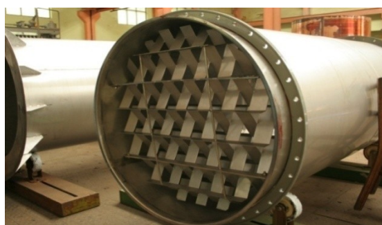
Рис. 7. Структурированные пере-распределители парового потока
