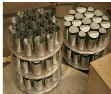
Рис. 5. Распределители жидкостного потока патрубкового типа для колонн диаметром до 400 мм включительно
