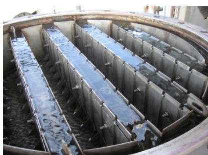
Рис. 6. Распределители жидкостного потока желобчатого типа для колонн диаметром более 400 мм
