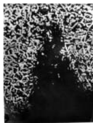
Рисунок 1 - Поперечное сечение образца трубы пиролиза после эксплуатации
