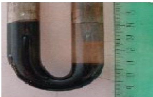
Рисунок 2. Рабочий орган установки для определения электро-кинетического потенциала эмульсии методом электрофореза
