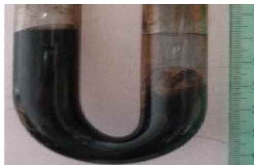
Рисунок 3. Ход эксперимента: эмульсия из левого колена поднимается в анодном пространстве (правое колено)
