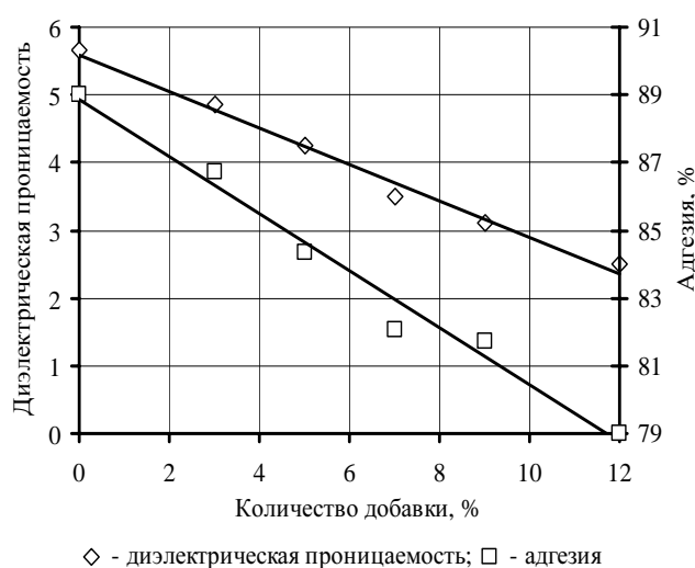
Рисунок 9. Зависимость диэлектрической проницаемости и адгезионных свойств модифицированных битумов от количества НМПЭ
