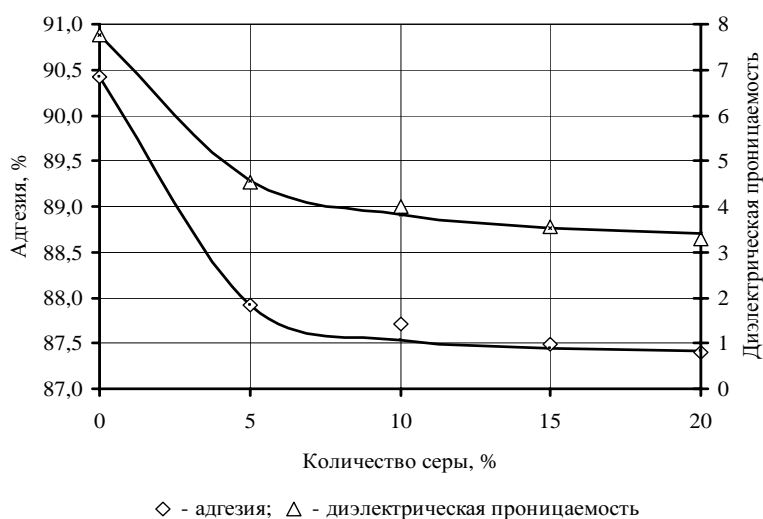
Рисунок 1. Зависимость адгезионных свойств и диэлектрической проницаемости серобитумов от количества серы
