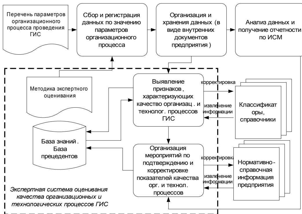
Рис. 4. Схема формирования экспертной информации по оценке качества организационных и технологических процессов ГИС
