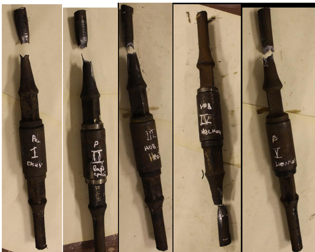
Рисунок 5. Результаты статического разрыва системы галтель-квадрат соединительная муфта на разрывной машине ИР-500
