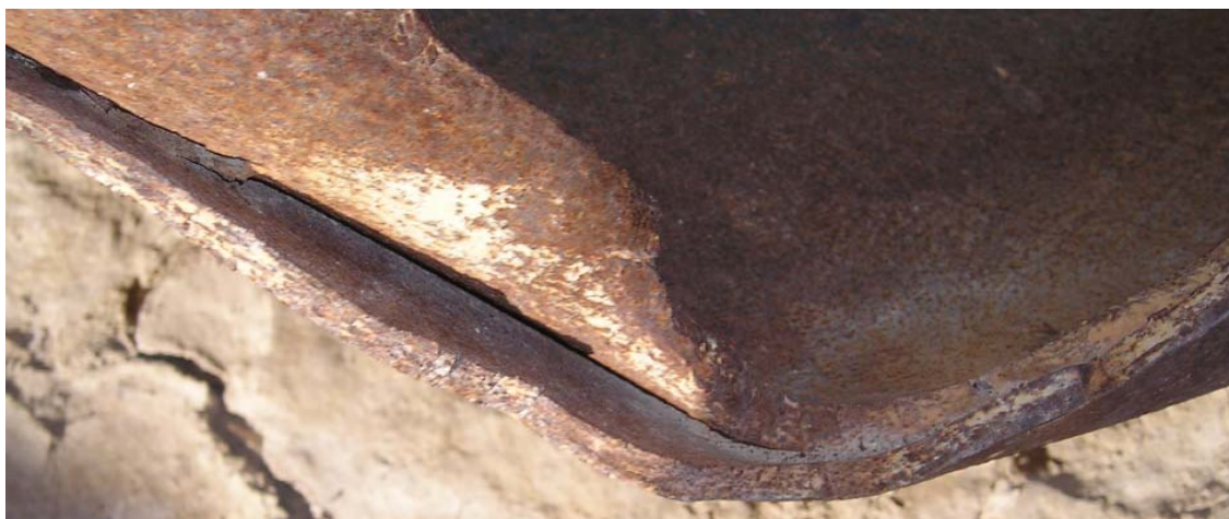
Рисунок. 5. Излом в очаговой зоне. Характерное для КРН расположение составляющих. Хрупкая ( 90^{\circ} ) составляющая со стороны внешней поверхности трубы и вязкий долом ( 45^{\circ} )
