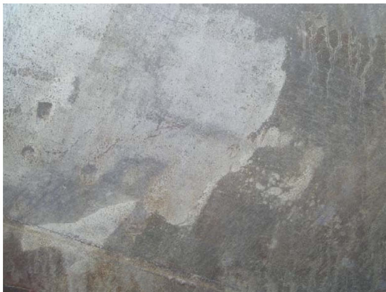
Рисунок 1. Катодные отложения (белого цвета) на внешней поверхности трубы
