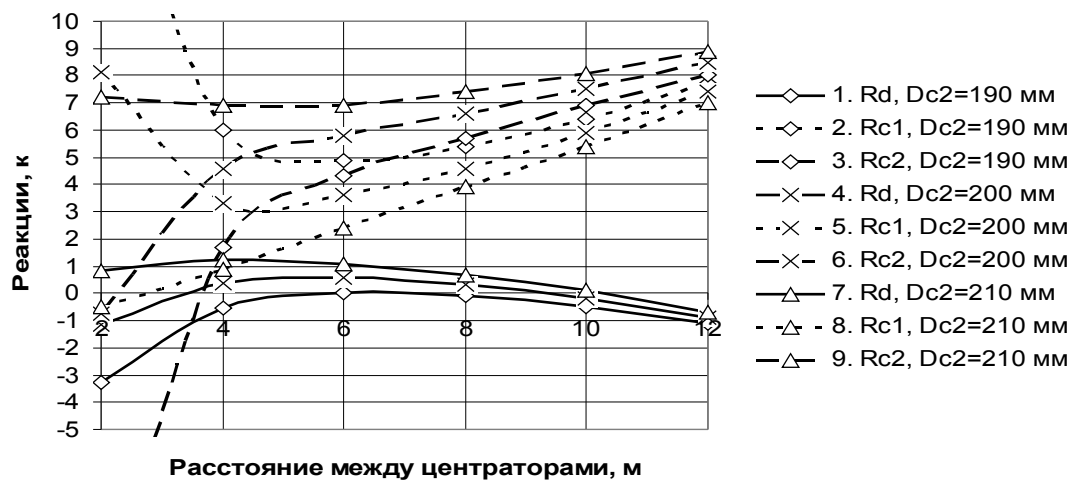
Рисунок 1. Реакции на долоте и центраторах D_{c1} = 214 мм; L_1 = 3,38 м; \alpha = 40^\circ
