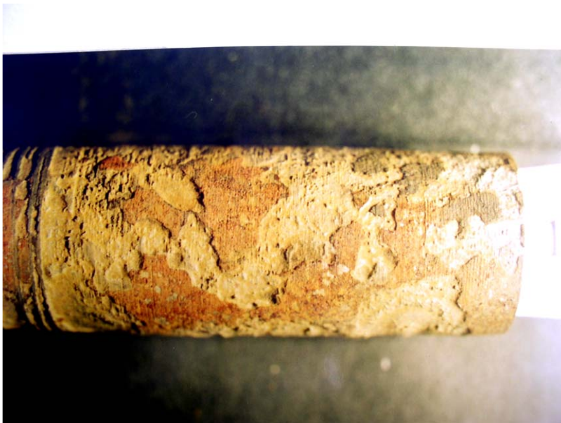
Рис. 2. Образец № 1. Импульсный температурный режим 30/40°C (поз. 3 ч.)
