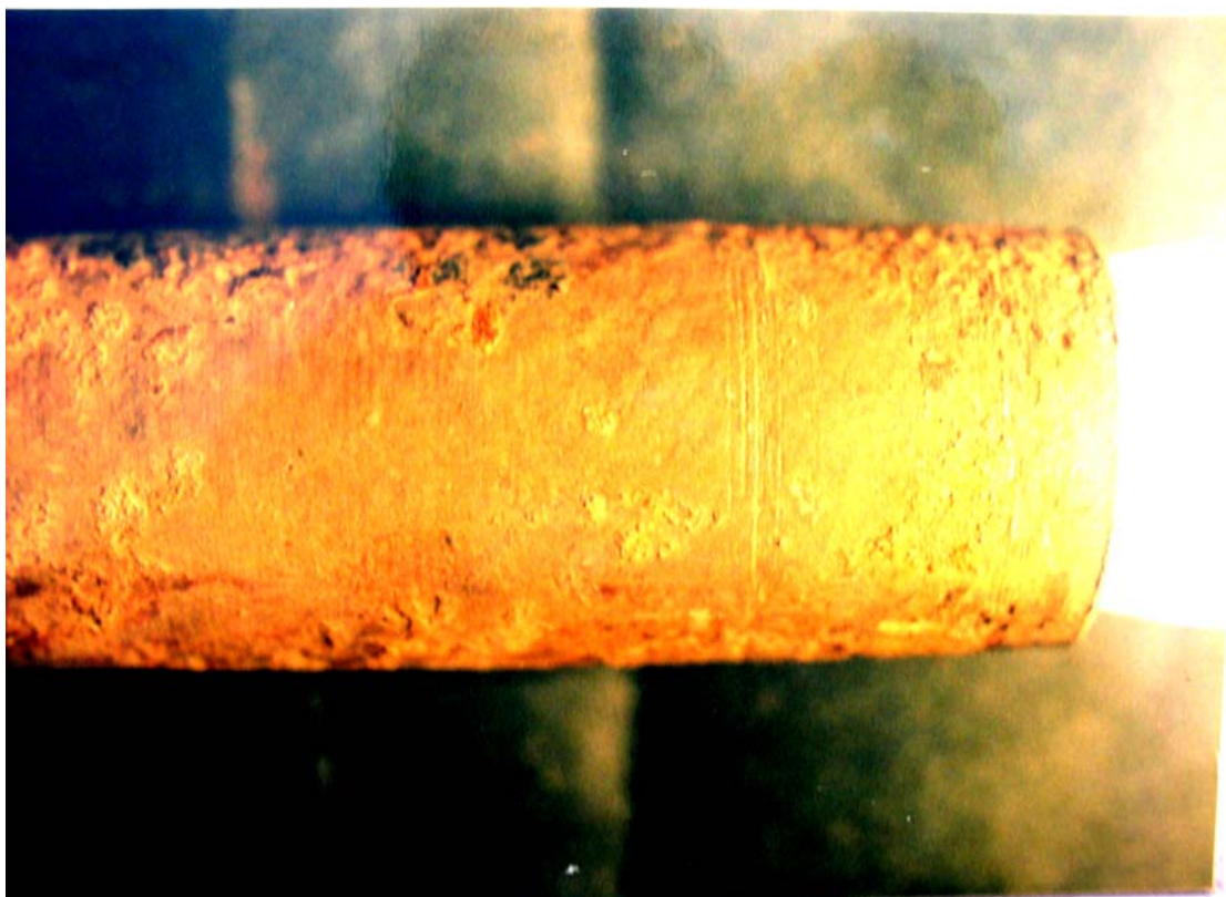
Рис. 4. Образец № 3. Контрольный. Температура t=34^{\circ}\text{C} (грунт с поз. 6 ч.)
