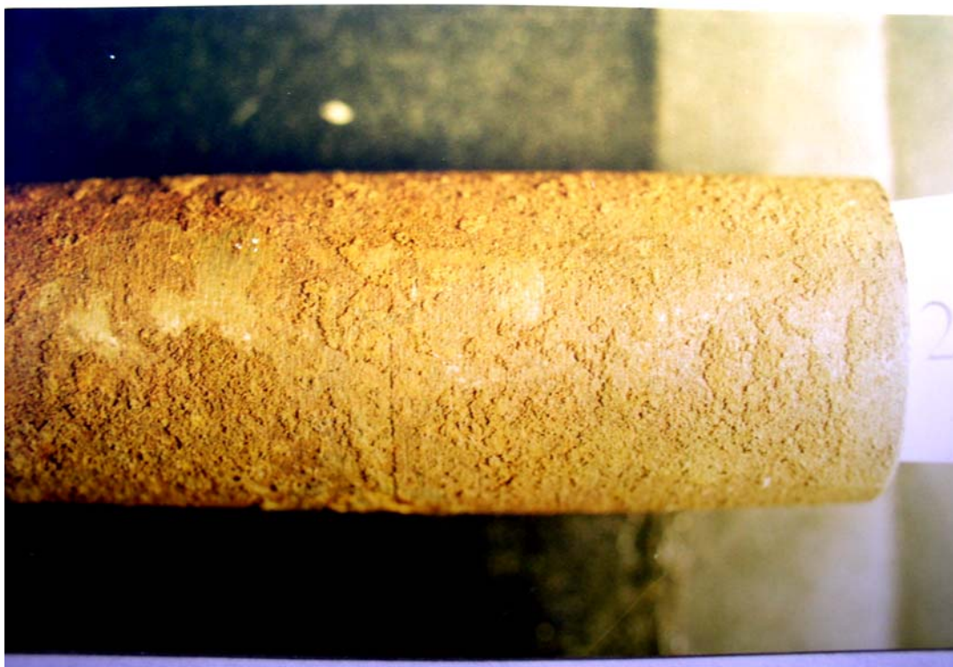
Рис. 3. Образец № 2. Контрольный. Температура t=33^{\circ}\text{C} (грунт с поз. 3 ч.)
