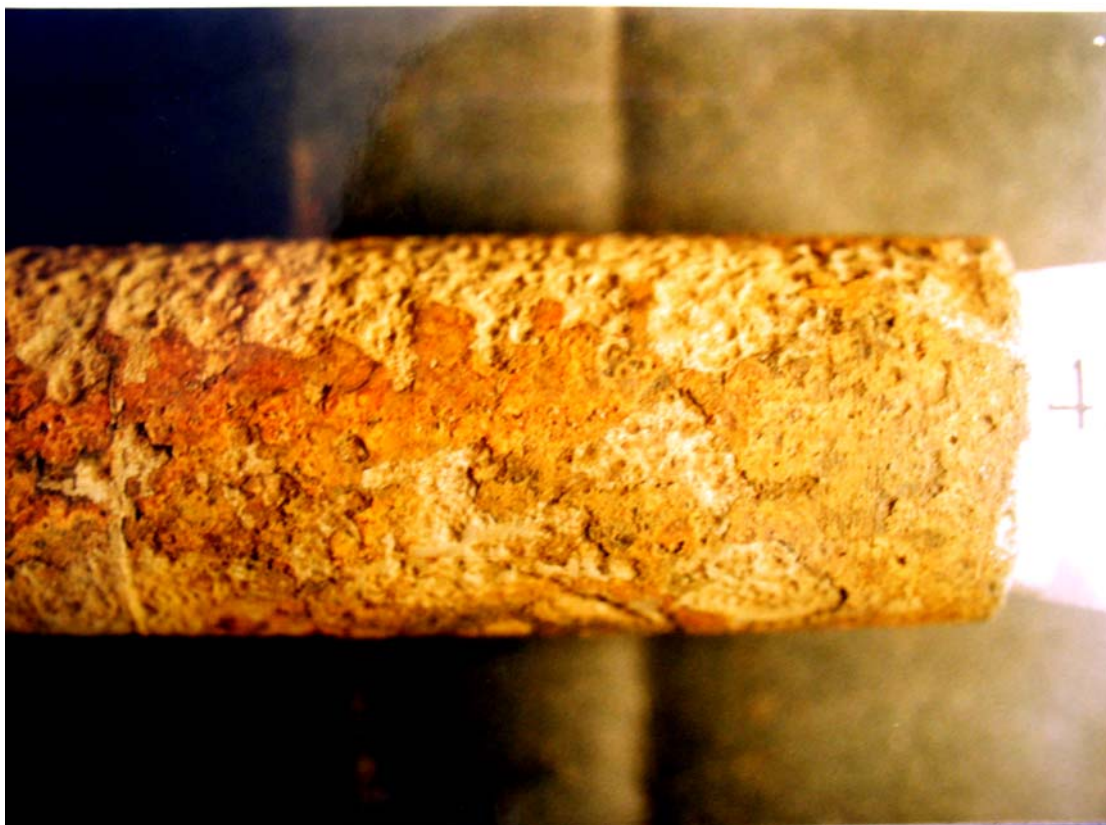
Рис. 5. Образец № 4. Импульсный температурный режим 31/42^{\circ}\text{C} (поз. 6 ч.)
