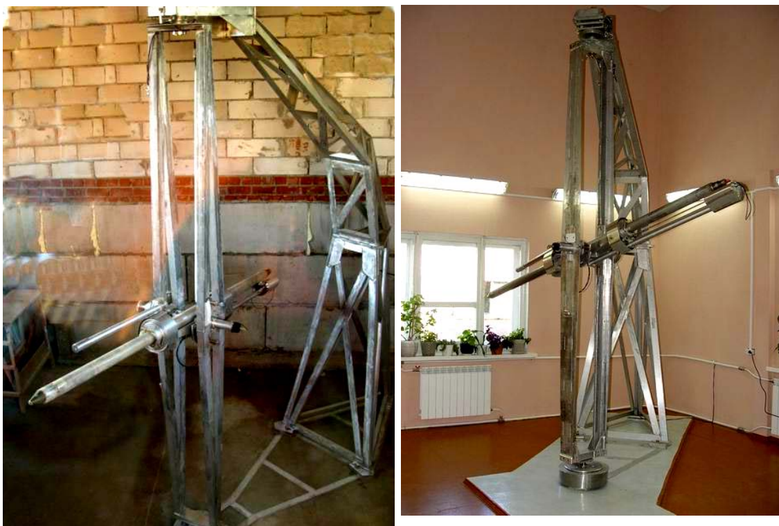
Рисунок 6. Внешний вид метрологической установки пространственной ориентации забойной и скважинной инклинометрической аппаратуры
